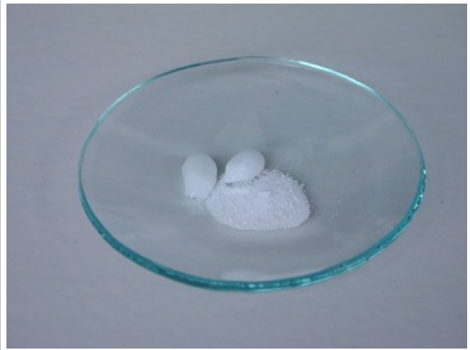
2. Die Analysensubstanz und 2 Natriumhydroxidplättchen werden auf ein Uhrglas gegeben.
