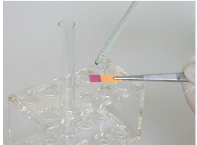
2. Die Lösung des Sodauszugs wird mit konz. Salzsäure angesäuert.
