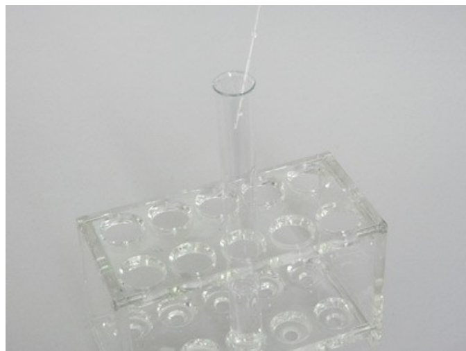
3. Die saure Lösung wird tropfenweise mit 2N Bariumchloridlösung versetzt.
