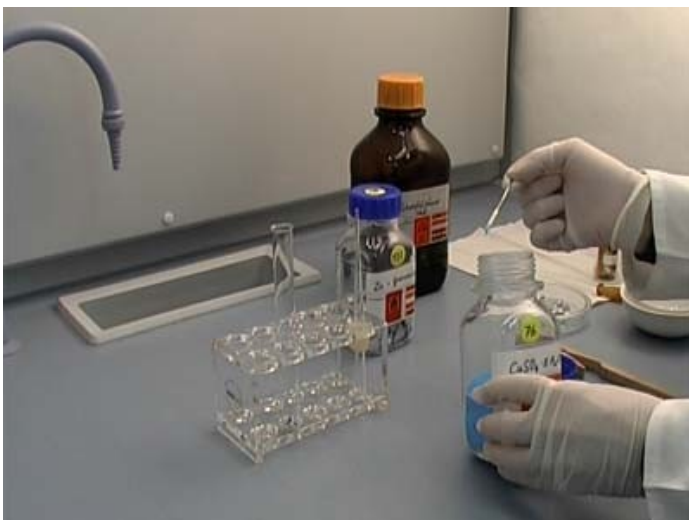
3. Zu der Zinkgranalie im Reagenzglas wird etwas Kupfersulfat gegeben.
