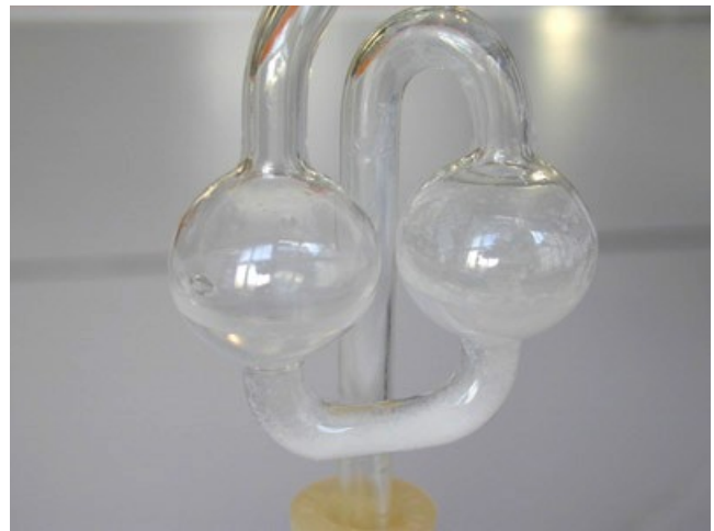
6. Bei Anwesenheit von Carbonat in der Analyse fällt weißes Bariumcarbonat im Gärröhrchen aus.
