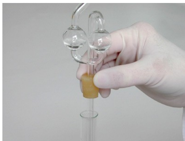
4. Das Reagenzglas wird sofort mit dem Gärröhrchen verschlossen.
