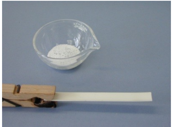
2. 3-5 der Analysenprobe werden mit dem zehnfachen Überschuss einer 1:1 Mischung aus KNO 3 und Na 2 CO 3 vermengt.
