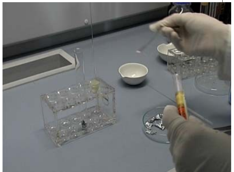
4. Die Analysesubstanz und etwa 3 - 4 verdünnte Schwefelsäure werden hinzugefügt.
