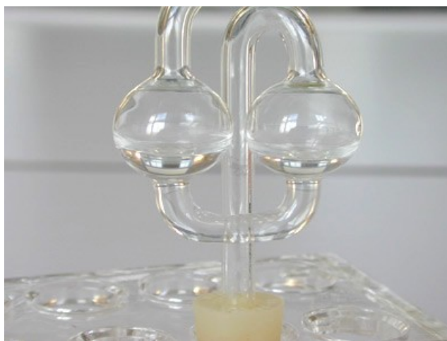
2. Ein Gärröhrchen wird in einen Gummistopfen gesteckt und mit klarer, gesättigter Bariumhydroxidlösung gefüllt.
