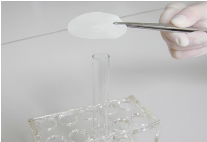
3. Das Reagenzglas wird mit einem bleiacetathaltigen Filterpapier abgedeckt.
