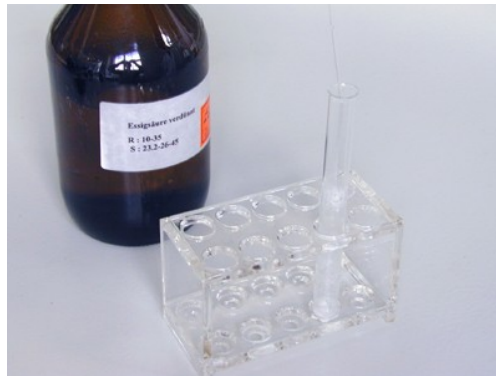
4. Beim Erhitzen der Mischung von Wasser und \text{PbCl}_2 löst sich der Niederschlag wieder auf
