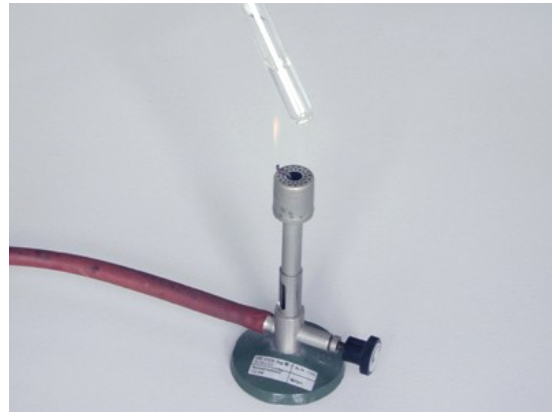
4. Beim Erhitzen der Mischung von Wasser und \text{PbCl}_2 löst sich der Niederschlag wieder auf
