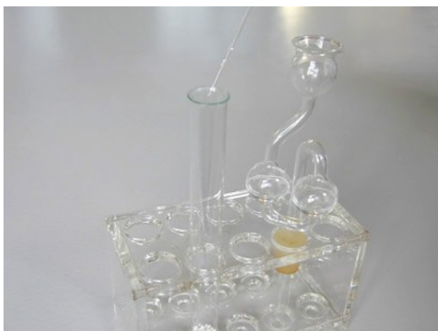
3. Im Reagenzglas wird die Analysenprobe mit verd. Salzsäure versetzt.
